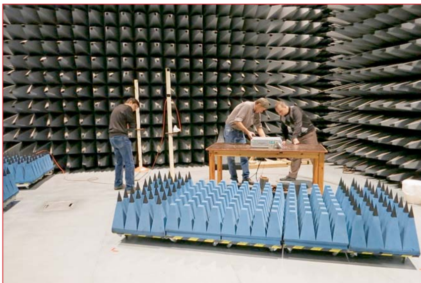
Ияфовские специалисты проводят испытания источника питания в безэховой камере.
